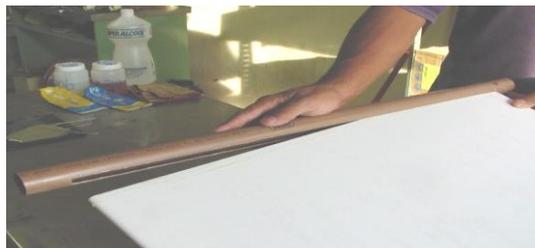
**Observación:** En el caso de montar dos o más colectores hacer 2 moldes (listones de madera) idénticos de 123cm cada uno y utilizarlos en todos los colectores para garantizar la distancia constante entre los tubos, lo que permitirá el fácil encaje de colector a colector.
