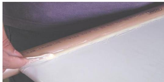
**8. Prueba de Pérdidas:** Tapar tres extremidades de cada colector, con tapones de 32mm y en la otra colocar un codo de 90° con un tubo de 3 metros de largo en la vertical. Se va a llenar con agua y por 15 minutos observar si existen pérdidas en las regiones que fueron pegadas. En caso de haber pérdidas reforzar el adhesivo en los lugares observados y hacer nuevamente la prueba.
