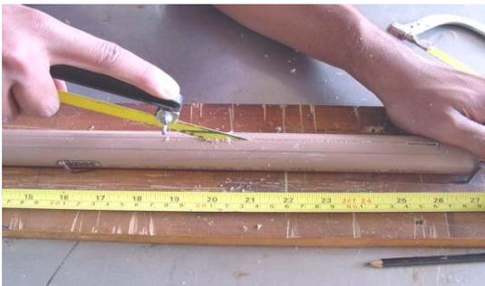
4. Una vez realizados los dos cortes y retirada la tira, dar acabado con la lija en las superficies cortadas y redondear, con lima redonda las extremidades del surco, hasta alcanzar el ancho original de la placa alveolar, de 61,5 cm. En seguida limpiar con alcohol.
