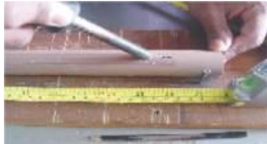
3. Introducir la punta de la hoja de la sierra e iniciar el corte. Haga movimientos lentos siguiendo el trazado, para no abrir un surco mayor o menor que lo necesario. En las puntas del surco, hacer cuidadosamente un corte transversal para poder retirar la tira de PVC.
